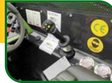
Joystick elettroidraulico Electro-hydraulic joystick
