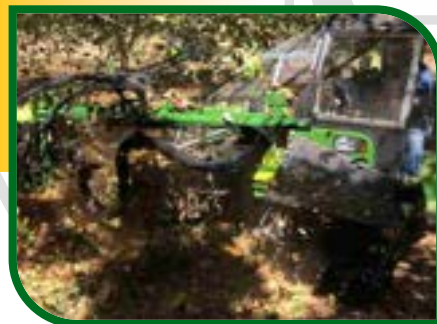
Spazzole controrotanti a controllo idraulico Frontal hydraulically controlled brushes
