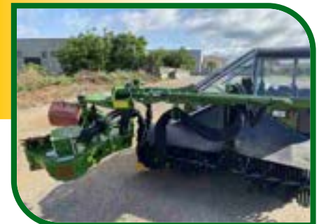
Pinza vibrante laterale a 45° Lateral shaking head (45°)
