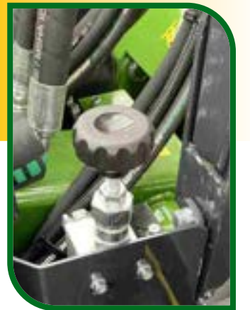
Valvola di regolazione pressione serraggio pinza Jaw closure pressure valve
