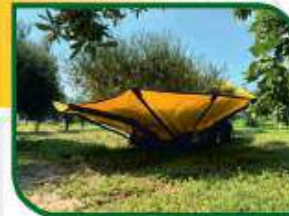
Ombrello da 5 o 6 m di diametro (max 7 m con prolunghe) Reverse umbrella of 5 or 6 m diameter (max 7 m with extension)
