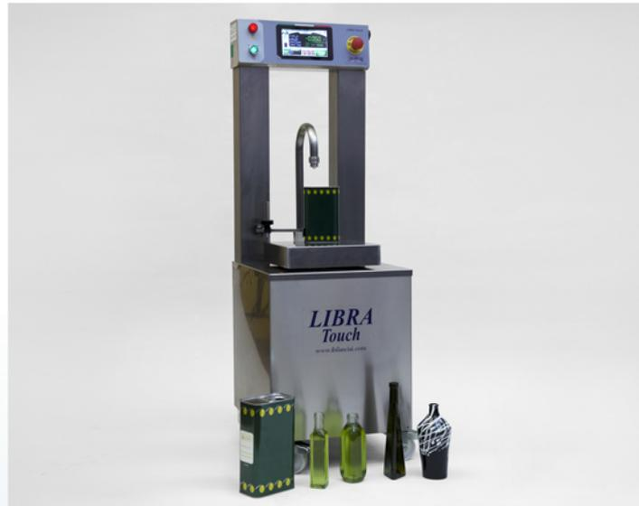
La LibraTouch è una riempì pesa lattine e bottiglie usata dalle aziende sia per uso industriale che per uso commerciale, ideale per l'olio extra vergine d'oliva. La macchina è completamente in acciaio inox, dotata di visualizzatore di peso touchscreen. Mostra in tempo reale il livello di riempimento e la conversione da litri a kg, con possibilità di scelta e creazione di nuovo formato. Omologabile CE-M.
