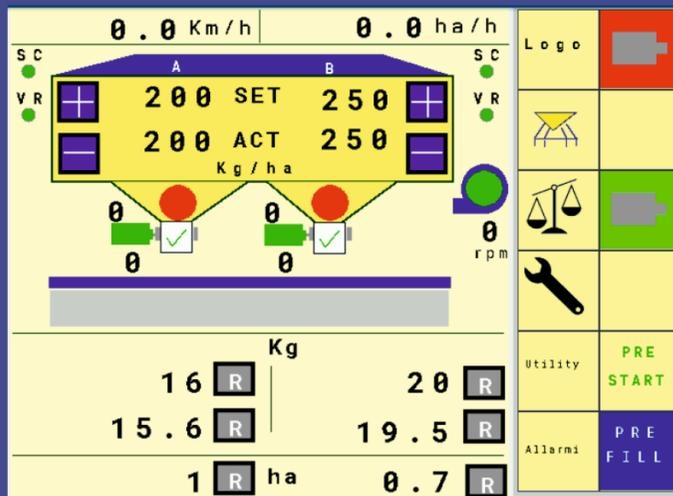
Controllo seminatrice Isobus dotato già nella versione base dei totalizzatori di lavoro (TC BAS) e delle mappe di prescrizione (TC GEO), valvole di sezione (TC SC) e sensori di flusso nella versione più completa. Dotazione di alto livello a partire dai motori Brushless ad alto rendimento, sensore di velocità GPS integrato e sensoristica completa per il controllo della macchina.
