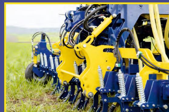
*Attacco ai bracci del sollevatore tramite sistema flottante con asole. Con questo sistema la seminatrice si adatta perfettamente alle condizioni del terreno. (Brevettato)*
