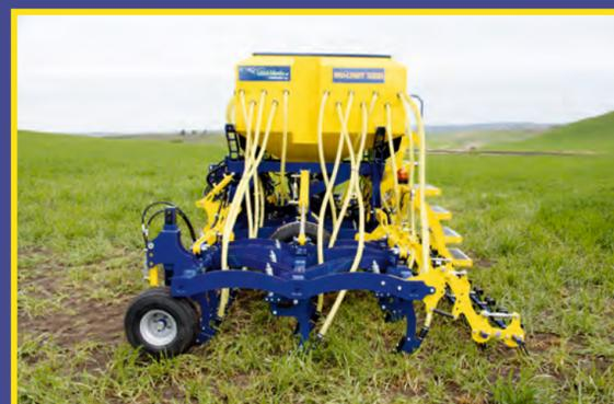
*L'apparato di semina è disposto su tre ranghi disposti ad una distanza di 70 cm con interfila da 16 cm.*
