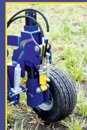
*Le ruote telescopiche alle ali, permettono un perfetto bilanciamento e precisione della profondità di semina*
