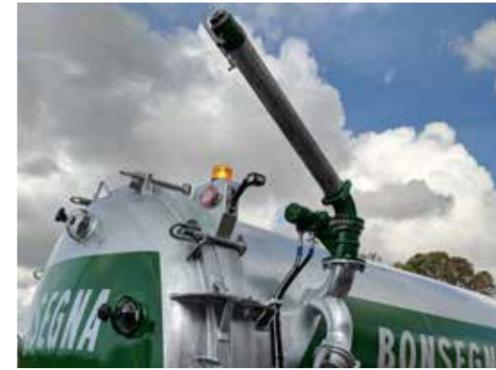
Ferrigatore montato lateralmente
